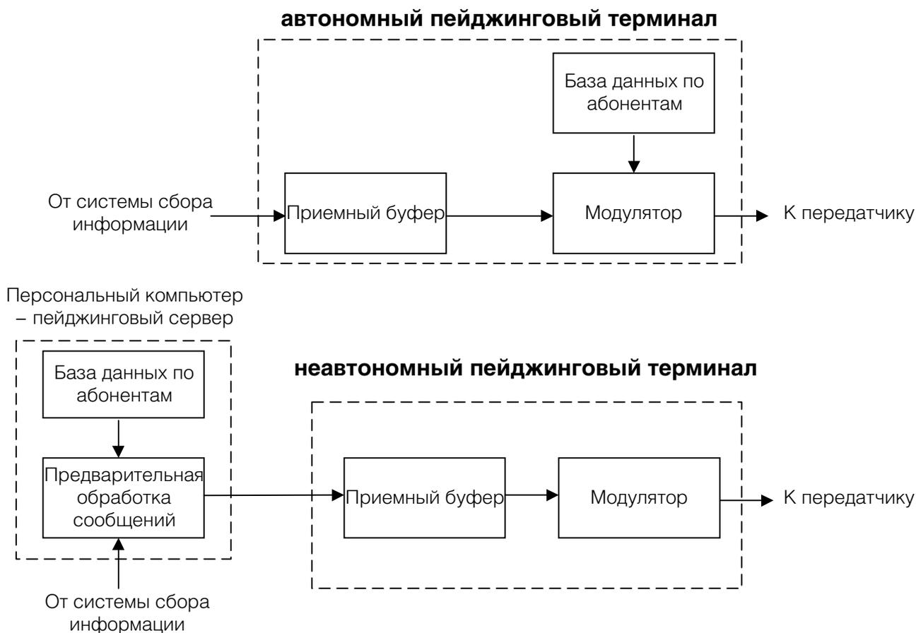
Автономный пейджинговый терминал содержит базу данных абонентов, в соответствии с которой и производится формирование низкочастотного модулирующего сигнала на передатчик. Обычно автономный терминал выполняется в виде специализированной микроЭВМ, однако при увеличении числа абонентов он становится очень дорогостоящим устройством. Это вынудило разработчиков отказаться от хранения базы данных абонентов внутри терминала и перейти к выпуску неавтономных терминалов.
